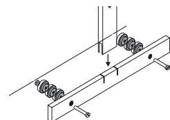
Per favore fate attenzione: per evitare di danneggiare l'asta di misurazione quando la si utilizza, è assolutamente necessario che l'arresto per i calcagni sia puntellato contro la parete! Per questo motivo dovete fissare dietro all'arresto per i calcagni tanti distanziatori, da appoggiare quello posteriore alla parete.
