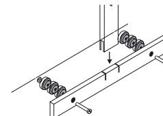
**Huom.:** Jotta mittauslatta ei vioitu käytössä, kantapäävaste täytyy ehdottomasti asettaa seinää vasten! Tästä syystä kantapäävasteen taakse täytyy kiinnittää niin monta välikelevy, että takimmainen levy tulee kiinni seinään.
