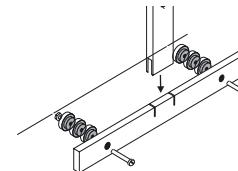
**Bemærk venligst:** For ikke at beskadige målepinden under brugen skal hælanslaget ubetinget støttes mod væggen! Derfor skal De befæstige så mange afstandsskiver bagved hælanslaget, at den bagste skive ligger på mod væggen.
