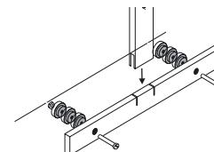
**Vennligst vær oppmerksom på:** Hælanslaget må ubetinget støttes opp mot veggen slik at målestaven ikke skades når den benyttes! Derfor må du feste så mange avstandsskiver bak hælanslaget at den bakre ligger an mot veggen.
